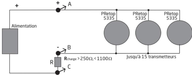
Pour la communication digitale HART® de 2-fils, les sorties de 15 transmetteurs au maximum peuvent être connectées en parallèle.
