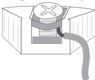
Les fils doivent être montés entre les plaques métalliques.
